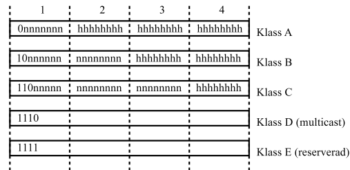
Figur 9.3: Illustration av adresseringsklasserna för IP-nummer. Figuren visar adressernas fyra byte: de bitar som givits värdet 1 eller 0 är fixerade, och variabeln n betyder att bitarna används för att numrera nätet, medan h numrerar datorerna i nätet ( h kommer av engelskans host , värddator.) T.ex. ser vi att det finns 2^7 = 127 möjliga klass A-nät med 2^{24} datorer i varje, ett av dem används för 127.0.0.1-adressen.
